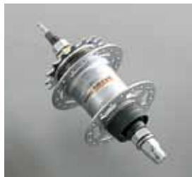
Левосторонний пыльник для использования без роллерного тормоза
